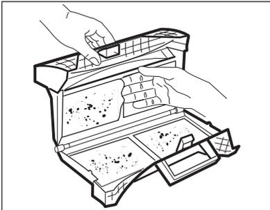
5. Bei Bedarf können Sie den Filter auch unter warmem Leitungswasser mit einer Bürste und/oder einen Staubsauger reinigen. Schließen Sie den Filter.
