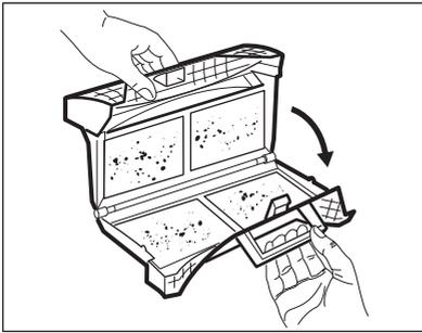
4. Reinigen Sie den Filter mit der feuchten Hand.
