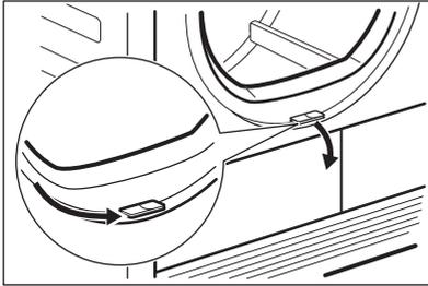
3. Drehen Sie beide Verriegelungsgriffe, um die Kondensatorabdeckung zu entriegeln.
