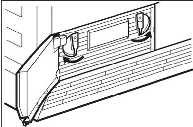
4. Lassen Sie die Kondensatorabdeckung herunter.
