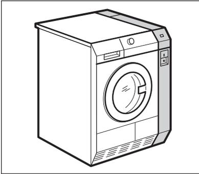
Wird das Gerät an einem öffentlichen Ort aufgestellt, kann es an ein Münzgerät angeschlossen werden.
