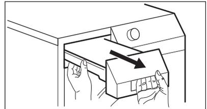
2. Ziehen Sie die Kunststoffverbindung heraus und entleeren Sie das Wasser in ein Waschbecken.
