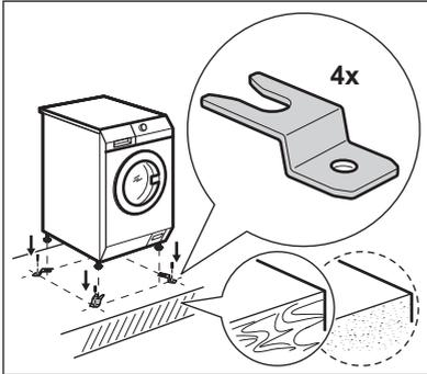
Wenn Sie das Gerät auf einem Betonsockel aufstellen, bestellen Sie bitte die geeignete Verankerungsvorrichtung.
