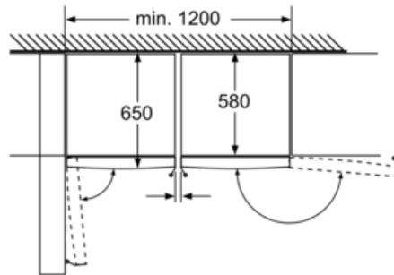
Schalen voll herausziehbar wenn das Gerät direkt an einer Wand platziert ist.
