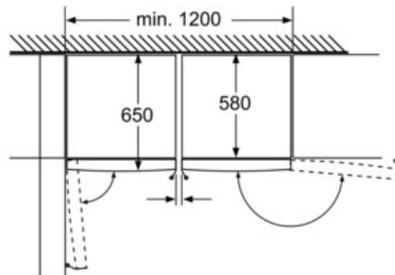
Schalen voll herausziehbar wenn das Gerät direkt an einer Wand platziert wird.
