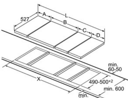
Bei Einbau zweier oder mehrerer Elemente nebeneinander ist ein oder sind mehrere Montagesätze erforderlich (2 Elemente 1 Montagesatz, 3 Elemente 2 Montagesätze usw.).
