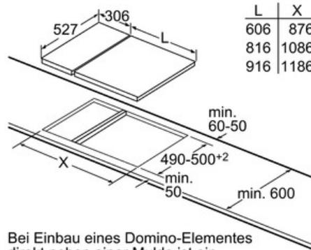
Bei Einbau eines Domino-Elementes direkt neben einer Mulde ist ein Montagesatz (HEZ394301) erforderlich.
