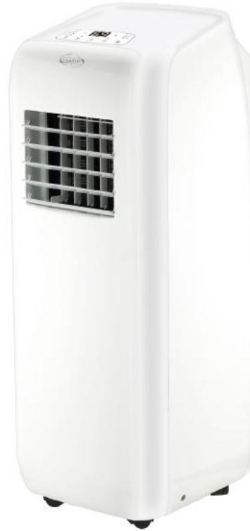
Monoblock Klimagerät zur Innenaufstellung mit Entfeuchtungsfunktion und 3 Lüfterstufen. Zur Klimatisierung von Büro- oder Privaträumen. Das im Kühl- oder Entfeuchtungsbetrieb anfallende Kondensat wird verdampft und mit der Abluft nach außen geleitet. Das Klimagerät kann durch das LED-Display auf der Oberseite des mobilen Klimagerätes oder per mitgelieferter Infrarotfernbedienung bedient werden. Geeignet für Raumvolumen bis ca. 80 m<sup>3</sup>.
