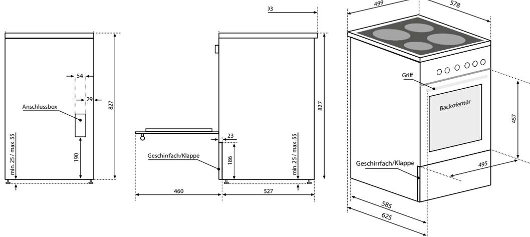
Mit den Stellfüßen kann das Gerät um max. 30 mm in der Höhe verstellt werden.
